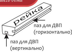
**A Установка арки.** Межстоечную пластину (ДВП) необходимо подогнать до нужного размера. Помните, пластины должны входить в паз стоек, поэтому по ширине они должны на 10мм быть больше толщины стены. Длина межстоечной пластины (ДВП) регулируется в зависимости, какие дополнительные декоративные элементы Вы используете. Рейка угловая (должна быть размером, равным толщине стены) позволяет скрыть щель между стыковкой горизонтальной и вертикальной межстоечной пластины (ДВП).
